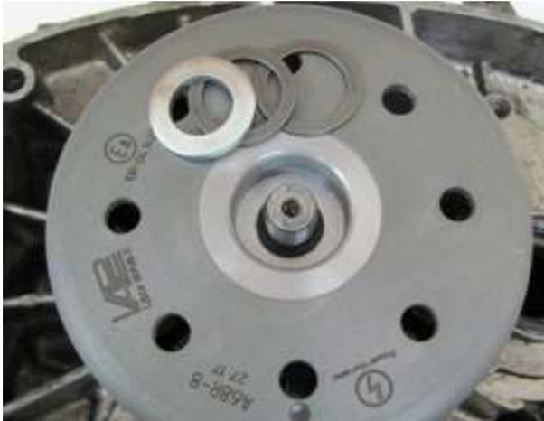
Der Rotor wird mit der originalen Mutter verschraubt. In diese Mutter greift später der Mitnehmer für den Drehzahlmesser.
