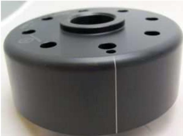
Sehen Sie sich jetzt den Rotor an, auf seinem Außenumfang finden Sie eine aufgelaserte Linie. Auch das ist eine Zündmarkierung.
