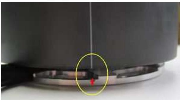
Entfernen Sie die Zündkerze und Entfernen Sie die Zündkerze und bringen Sie einen Kolben (egal welchen) in den oberen Totpunkt (OT). Da das ganze per Kickstarter kompliziert ist, setzen Sie den neuen Rotor locker auf den Kurbelwellenstumpf um ihn zum Drehen der Kurbelwelle zu nutzen.
