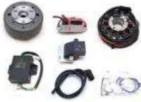
Lichtmagnetzündanlage mit integrierter, drehzahlabhängiger, vollelektronischer Zündung. Lichtleistung 12V/180W Gleichstrom. Kontaktlose elektronische Zündung mit eigener Stromversorgung innerhalb der Anlage. Ersetzt die alte Lichtmaschine, Fliehkraftversteller, Unterbrecher, Zündspule. Sie benötigen an Ihrem Motorgehäuse keine Veränderungen. Sie können das System komplett ohne Batterie fahren (bitte aber unsere [Hinweise zum Fahren ohne Batterie](#) beachten).
