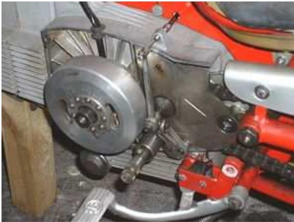
Entfernen Sie Lichtmaschine und die Zündspule.
