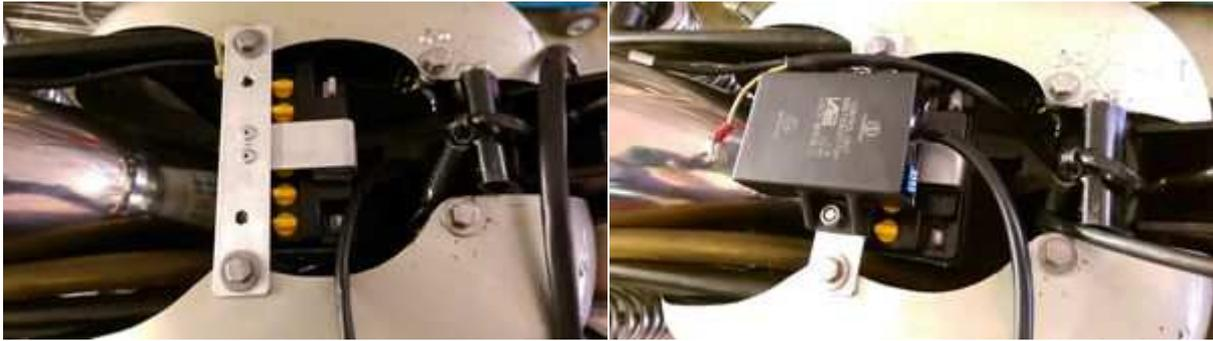
Sehen Sie sich bitte bei der Montage der Steuereinheit den kleinen blauen Schalterblock an der oberen Schmalseite der schwarzen Zündverstelleinheit an. Hier sind 4 kleine, von uns voreingestellte Schalter, die verschiedene Zündverstellkurven wählen.
