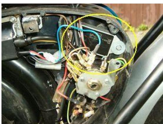
**- Upevnění regulátoru/vyrovnávače:**
