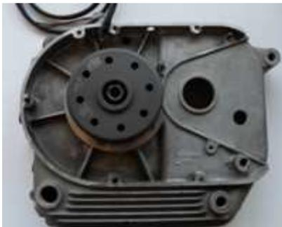
Ersetzt den originalen Magneto für die Erzeugung von Lichtstrom mit Ausgangsleistung von 12V/150W, nicht aber die Zündung. Die Version mit Zündung haben wir wegen größerer Probleme beim Start (heftiges Rückschlagen) eingestellt.
