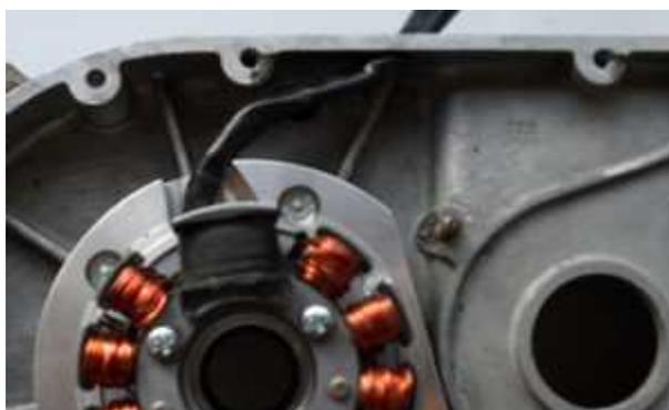
Führen Sie das Kabel durch den Kabelausgang nach außen. Beachten Sie bitte den Durchmesser, dies ist die einzige Stelle, an der Sie eventuell die Ausgangsbohrung etwas vergrößern müssen. Benutzen Sie bitte eine Gummitülle als Schutz für die Kabel.
