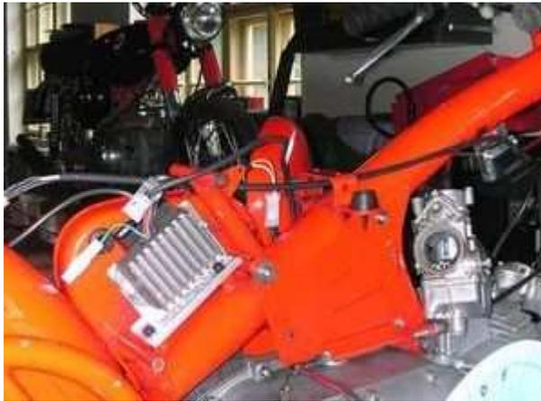
Nun muß der neue Regler/Gleichrichter einen Platz am Motorrad finden. Der Regler ist hinreichend dimensioniert und benötigt keine Lage im Strom des Fahrtwindes. Hier ein Einbauvorschlag.
