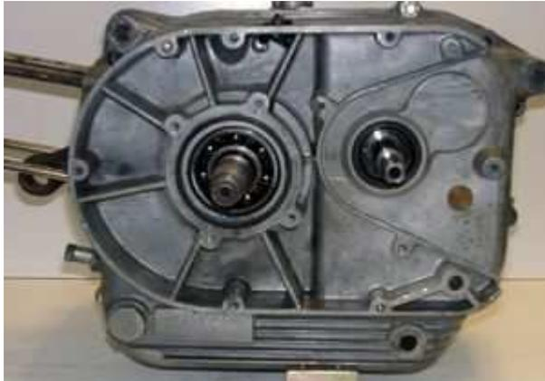
Nehmen Sie den Limadeckel ab. Klemmen Sie alle Kabel an der Lichtmaschine ab und ziehen Sie die Kabel aus dem Motorgehäuse. Schneiden Sie aber zunächst keine ab.
