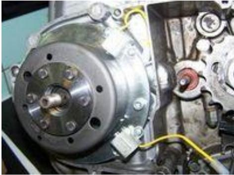
**Ersatzsystem Alternator/elektronische Zündung, passend für Yamaha XS650**
