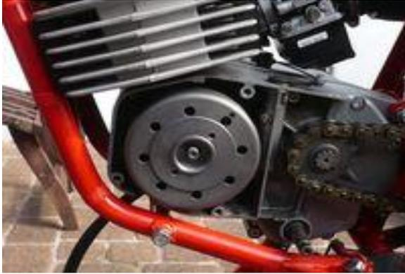
**Lichtmaschine/elektronische Zündung für Motoren Minarelli P6 und K6 50/80ccm**
