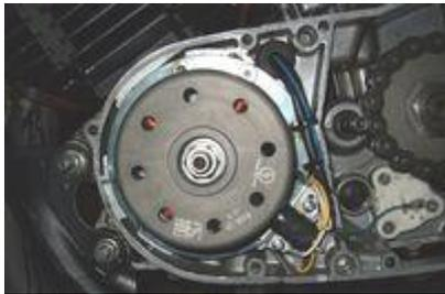
Dies ist kein komplettes Zündsystem. Nur Alternator zur Erzeugung von Lichtstrom mit nominal 12VDC (13.8V) sowie 2 Impulse je Umdrehung von einem [VAPE Sensor S01](#) ausgelöst über [2 gerade Geberzeichen](#).
