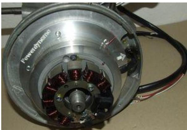
Setzen Sie die Statorspule wieder auf die Grundplatte. Die Spule muss dort recht hart einrasten. Setzt Sie nur weich auf die Platte auf, ist mit großer Sicherheit ein Kabel darunter eingeklemmt!
